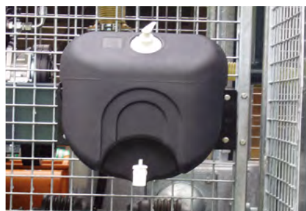
Réservoir d'eau de lavage
